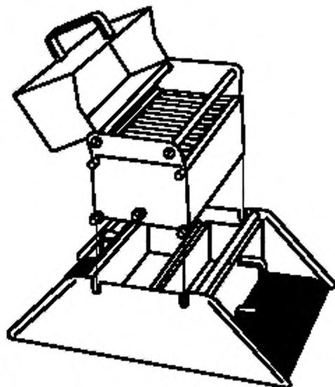
Рисунок А.2 — Множественно-щелевой делитель с системой сортировки
