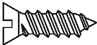
Рисунок 1 — Самонарезающий формирующий винт (3.6.10)
