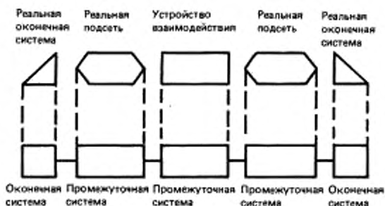
Рисунок 4 — Взаимосвязь реальных подсетей посредством отдельного устройства взаимодействия
