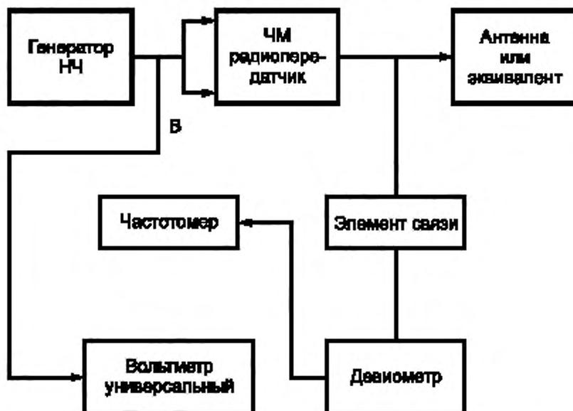
Рисунок 1 — Схема измерений параметров систем стереофонического радиовещания
