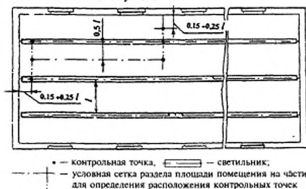
Рисунок А2 — Расположение контрольных точек при измерении минимальной освещенности помещения от светильников, принимаемых за линейные излучатели
