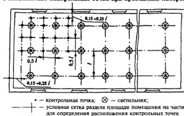
Рисунок А1 — Расположение контрольных точек при измерении минимальной освещенности помещения от светильников, принимаемых за точечные излучатели
