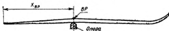
BP — центр тяжести; X_{BP} — расстояние от центра тяжести до заднего конца лыжи
