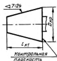
Рисунок 2 — Конусный контрольный калибр-пробка
