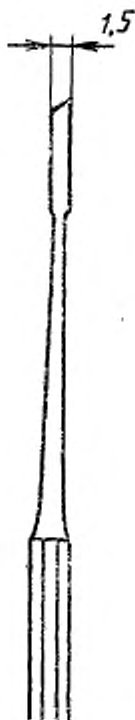
Рисунок 13 — Прямое долото со скошенным лезвием, правое
