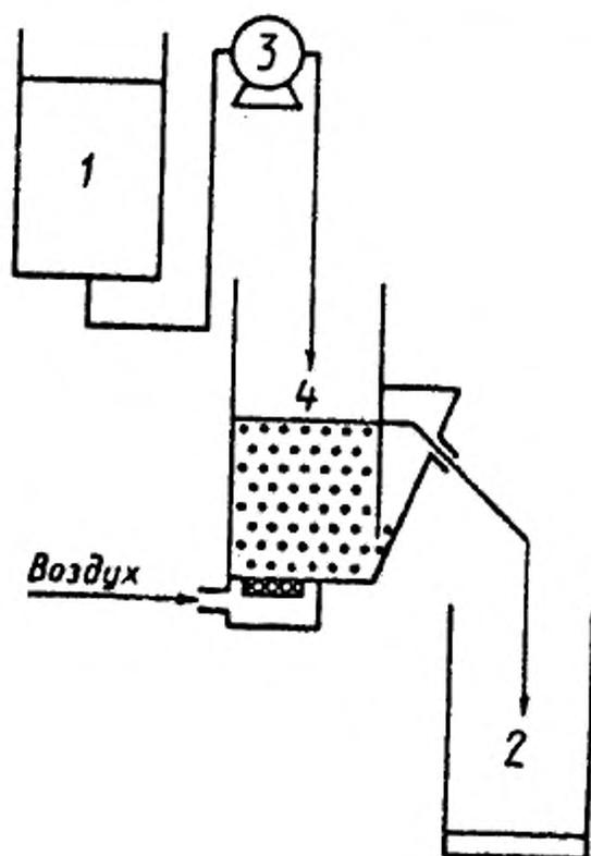
1-2 - емкости для загрязненной и очищенной сточной воды; 3 - дозатор
