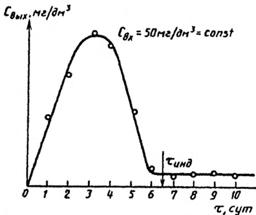
Рисунок Д.1 — Концентрация алкилбензолсульфоната на основе *n*-парафинов в очищенной сточной воде в зависимости от продолжительности испытаний
