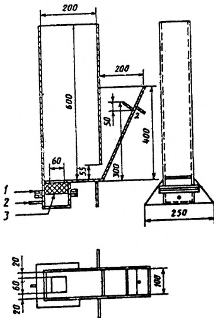
1 – фланцевое соединение; 2 – штуцер; 3 – фильтровая пластина
