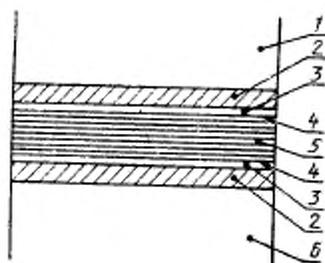
1 — верхняя нагревательная плита; 2 — прессовая подушка (10 слоев асбестовой ткани или крафт-бумаги); 3 — компенсационная пластина (хромированная сталь, толщиной 2 мм); 4 — прокладочный материал (например, триацетатная пленка); 5 — стана; 6 — нижняя нагревательная плита.
