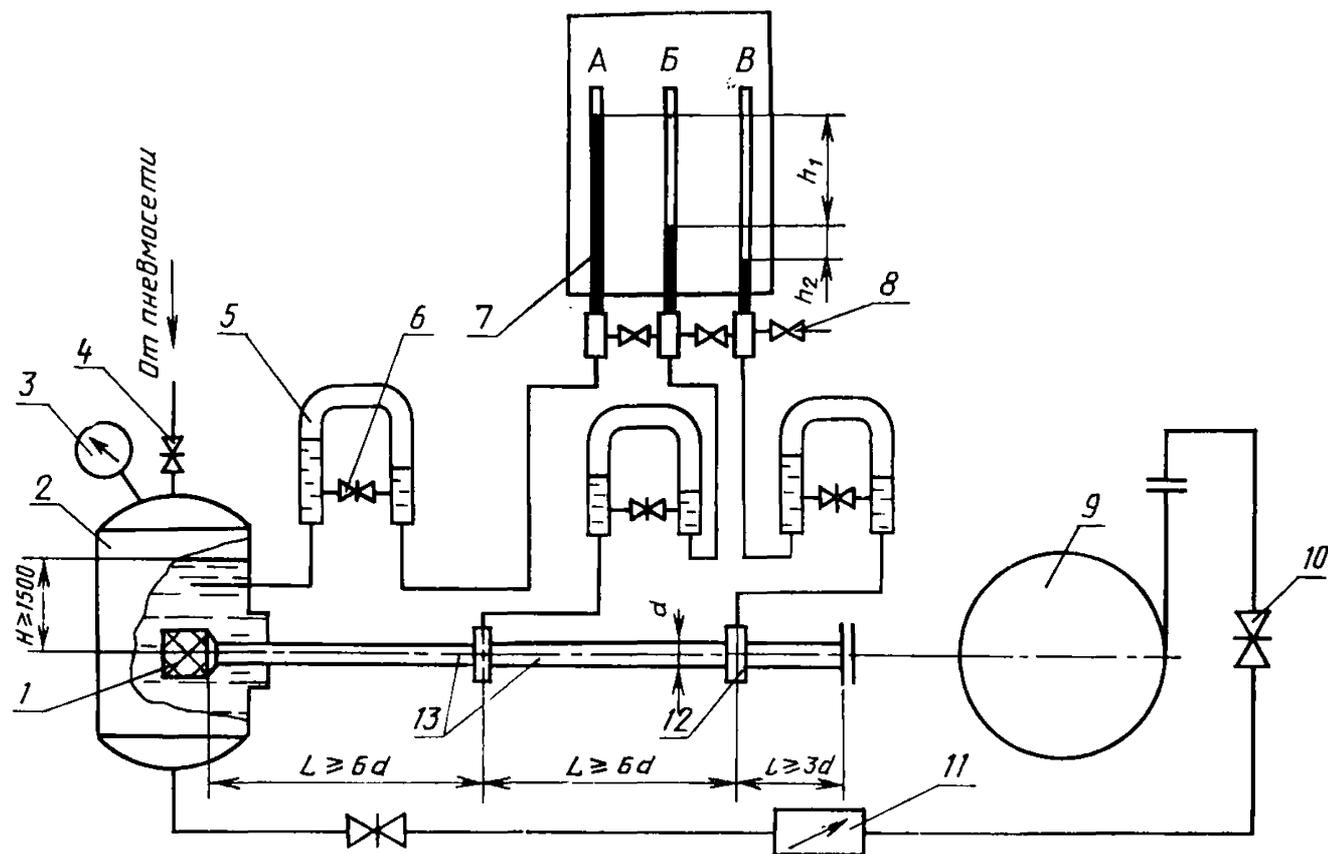
1—изделие испытываемое 2—бак ( $V > 4 \text{ м}^3$ ); 3—манометр; 4—кран; 5—демпфер; 6—кран; 7—пьезометр; 8—кран проливочный; 9—насос центробежный; 10—задвижка; 11—расходомер; 12—камера уравнивающая; 13—участок мерный
