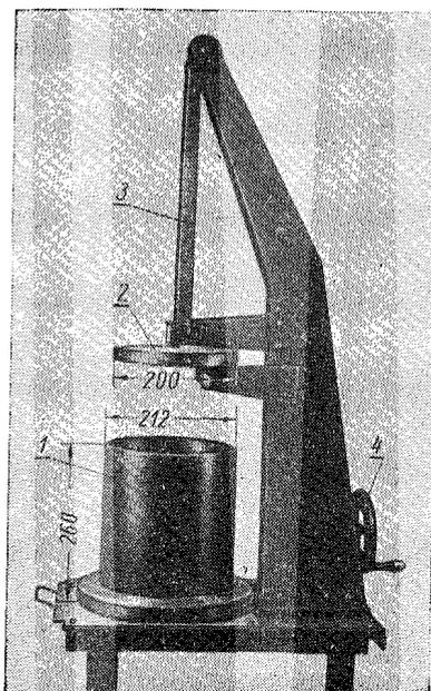
Сверху на минеральную вату опускают при помощи подъемного устройства 4 металлический диск 2 весом 7 кг, что соответствует давлению 0,02 кг/см<sup>2</sup>. Под нагрузкой вата выдерживается в течение 5 мин. Высоту сжатого слоя минеральной ваты в цилиндре определяют по шкале, находящейся на стержне 3.
