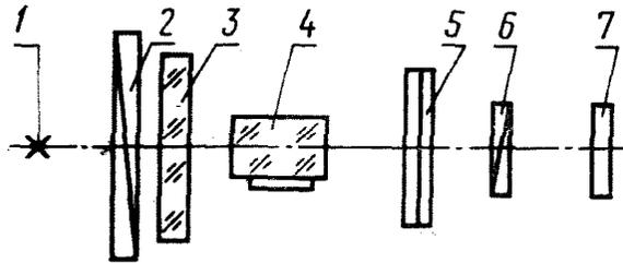
1 — источник света; 2 — поляризатор; 3 — матовое стекло; 4 — образец; 5 — пластина  $\lambda/4$  (разность хода  $135 \pm 10$  нм); 6 — анализатор; 7 — зеленый светофильтр (с максимальным светопропусканием при длине волны  $\lambda = 540$  нм)
