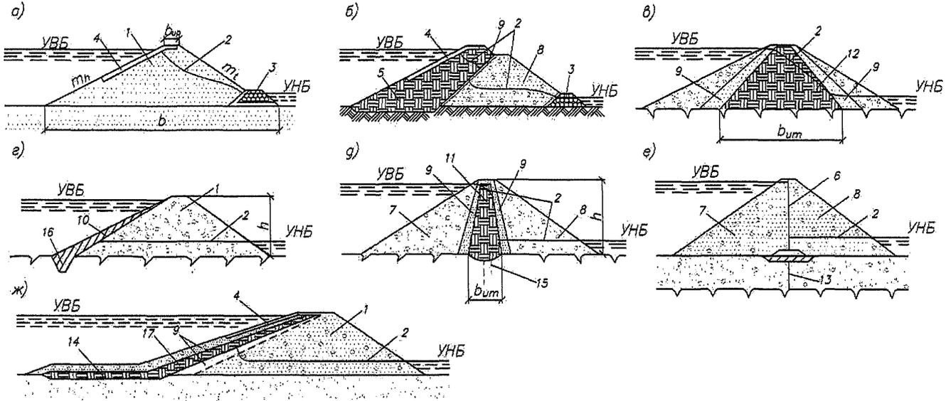
*a* – ж – см. таблицу 3; 1 – тело плотины; 2 – поверхность депрессии; 3 – дренаж; 4 – крепление откоса; 5 – верховая противofильтрационная призма из негрунтовых материалов; 6 – диафрагма; 7 – верховая призма; 8 – низовая призма; 9 – переходные слои; 10 – экран из негрунтовых материалов; 11 – грунтовое ядро; 12 – центральная грунтовая противofильтрационная призма; 13 – шпунт или стенка; 14 – понур; 15 – инъекционная (цементационная) завеса; 16 – зуб; 17 – грунтовый экран;
