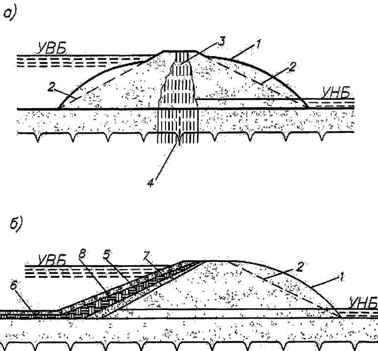
а, б – см. таблицу 7; 1 – навал из породы, образованный взрывом; 2 – контур расчетного профиля; 3 – инъекционное ядро; 4 – инъекционная завеса; 5, 6 – экран и понур из глинистого грунта; 7 – переходный слой; 8 – защитный слой
