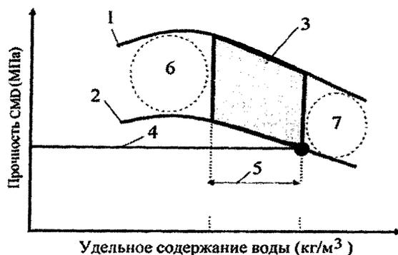
1 – смесь с наиболее крупным гранулометрическим составом; 2 – смесь с наименее крупным гранулометрическим составом; 3 – рабочая область смеси CMD, превышающая заданную проектную прочность; 4 – значение проектной прочности CMD; 5 – диапазон удельного содержания воды, гарантирующей заданную прочность; 6 – область показателей прочности при недостатке воды; 7 – область показателей прочности при избытке воды
