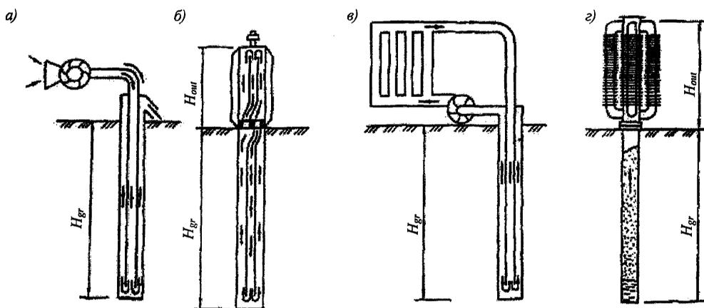
а – воздушное с принудительной циркуляцией воздуха; б – жидкостное с естественной конвекцией теплоносителя; в – жидкостное с принудительной циркуляцией теплоносителя; г – парожидкостное;  $H_{gr}$  – глубина СОУ;  $H_{out}$  – высота наземной части СОУ
