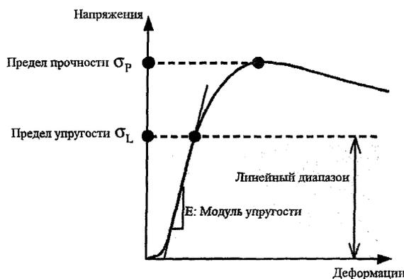
**Рисунок П.3 – Типовая зависимость «напряжения – деформации» для CMD при одноосном сжатии**
