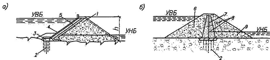
а, б – см. таблицу 7; 1 – тело плотины из каменной наброски; 2 – цементационная завеса; 3 – бетонная опорная плита; 4 – экран из негрунтовых материалов; 5 – подэкранный слой; 6 – верховая призма; 7 – диафрагма из негрунтовых материалов; 8 – переходные слои; 9 – низовая призма
