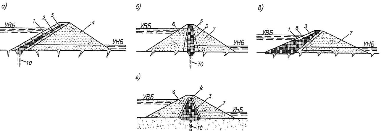
а - 2 - см. таблицу 7; 1 - крепление верхового откоса; 2 - грунтовый экран; 3 - переходные слои (обратные фильтры); 4 - упорная призма; 5 - грунтовое ядро; 6 - верховая призма; 7 - низовая призма; 8 - верховая грунтовая противофильтр-трапеционная призма; 9 - центральная грунтовая противофильтр-трапеционная призма; 10 - цементация
