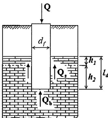
$Q$  – вертикальная нагрузка на сваю;  $Q_b$  – вертикальная нагрузка, воспринимаемая пятой сваи,  $Q_b/Q = \eta$ ;  $Q_s$  – вертикальная нагрузка, воспринимаемая боковой поверхностью сваи,  $Q_s/Q = 1 - \eta$ .
