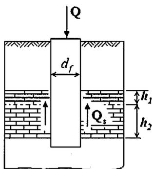
$Q$  – вертикальная нагрузка на сваю;  $Q_s$  – вертикальная нагрузка, воспринимаемая боковой поверхностью сваи,  $Q = Q_s$ ;  $h_1, h_2, \dots, h_n$  – толщины слоев скального грунта
