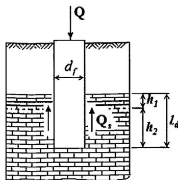
Рисунок Б.2 – Прорезание свай толщи скальных грунтов с заделкой в них
