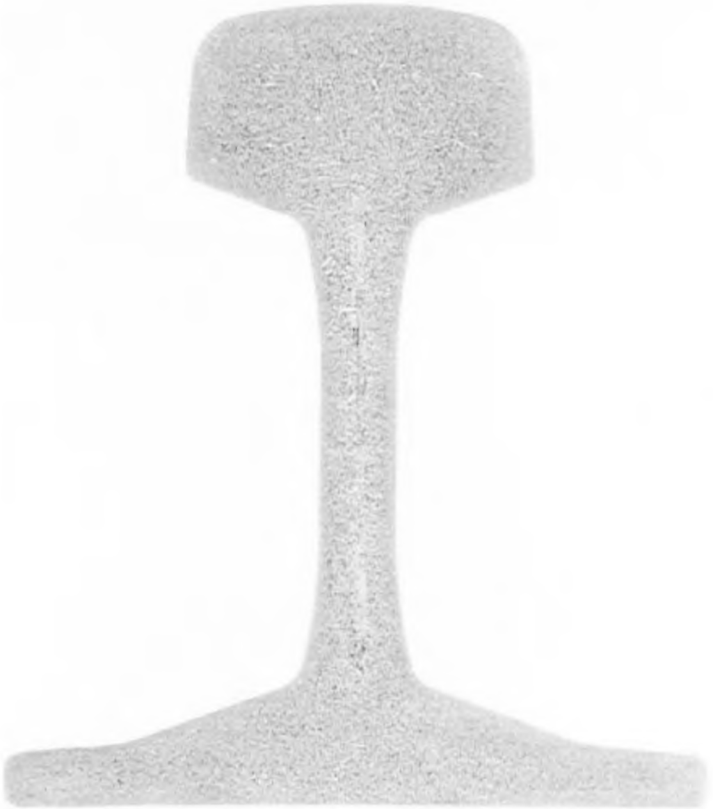
Рисунок И.5 — Осевая ликвация в шейке, простирающаяся в головку и (или) в подошву (серный отпечаток)
