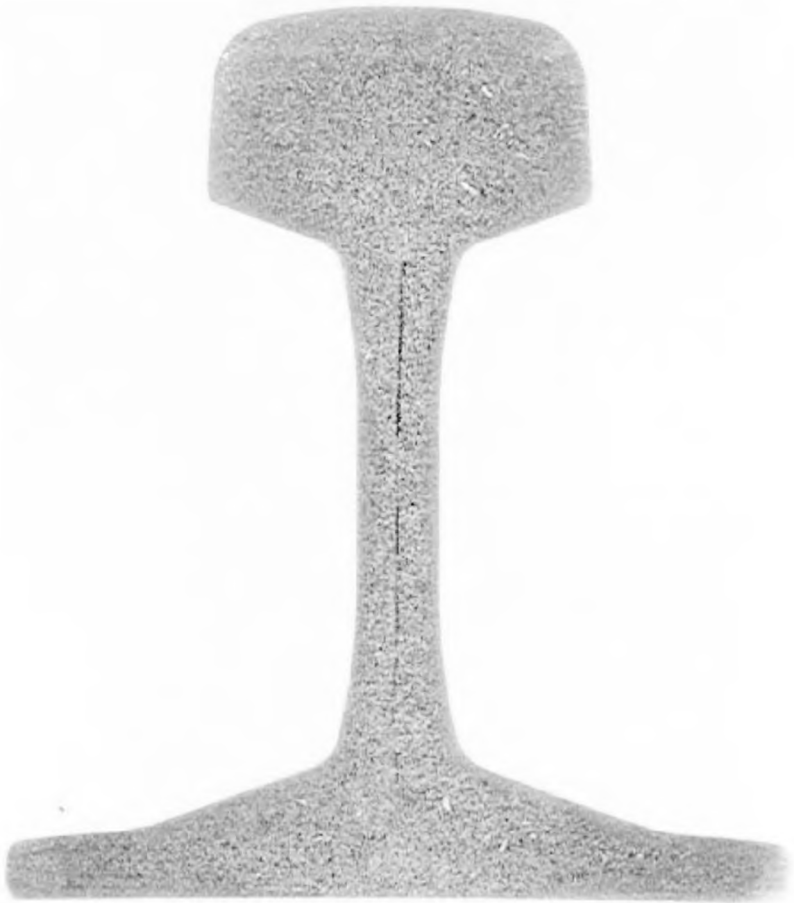
Рисунок И.4 — Незначительная прямая ликвация (серный отпечаток)
