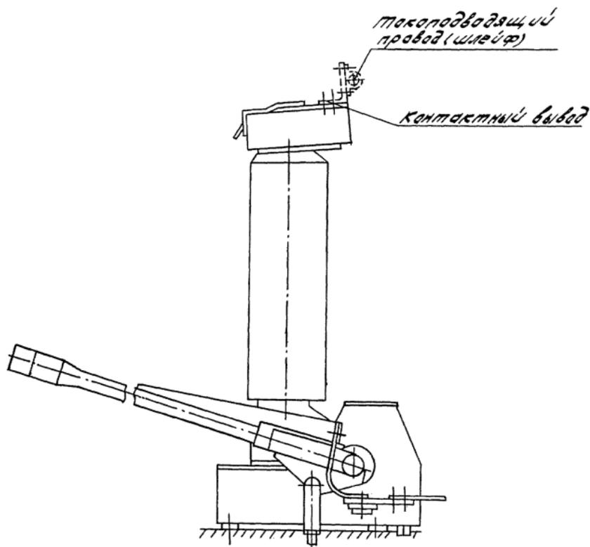
Рис. 4 Схема подсоединения токоподводящего провода к контактному выводу короткозамыкателей.
