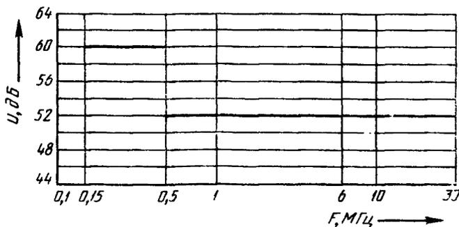
$U$  — напряжение радиопомех;  $F$  — частота
