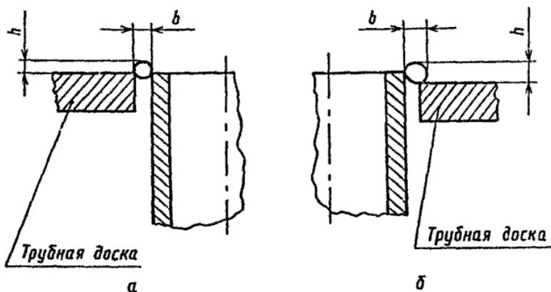
а -- заделка «заподлицо»; б — заделка с выступающим концом трубы
