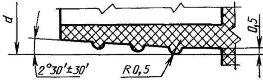
Пример условного обозначения пробки типа 4 исполнения 1. Заменить значение диаметра пробки: 20 на 6.
