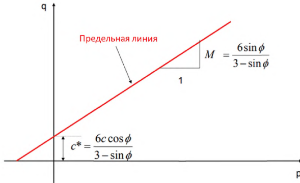
Рисунок 11 – Представление трехосных испытаний в пространстве p - q
