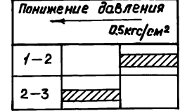
Диаграмма замыканий контактов датчика реле давления Д210-11 Н7-Р1
