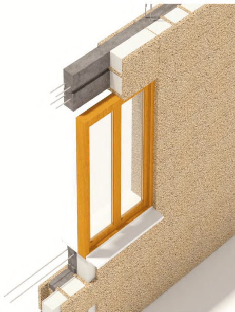
Рисунок М.17 – Устройство оконных проемов в кладке наружной стены с перемычным блоком над проемами
