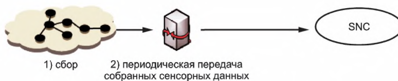
Рисунок 3 — Сбор сенсорных данных: режим push
