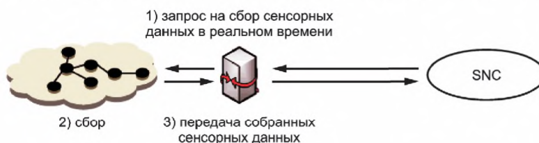
Рисунок 4 — Сбор сенсорных данных: режим pull — мгновенный режим
