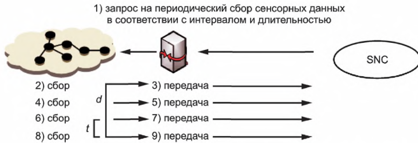
Рисунок 5 — Сбор сенсорных данных: режим pull – непрерывный режим
