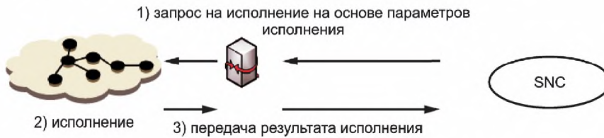
Рисунок 8 — Оперирование исполнительными устройствами
