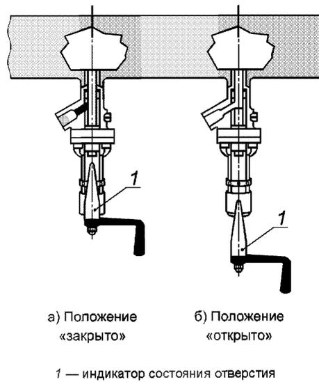
Рисунок 2 — Схема пробоборного крана поршневого типа
