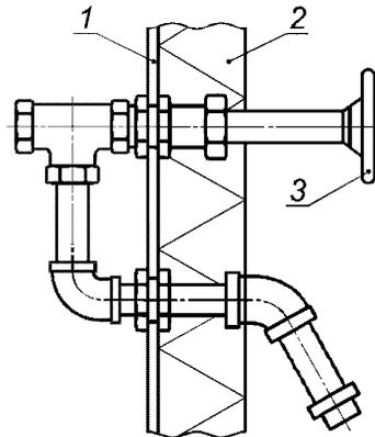
1 — изолированная стенка резервуара; 2 — слой изоляции; 3 — сливной кран
