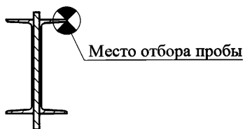
Рисунок 38 – Схема отбора пробы из незакрепленного элемента профиля – полки швеллера
