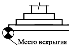
Рисунок 6 – Пример схемы расположения места вскрытия в столбчатом фундаменте
