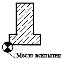
Рисунок 5 – Пример схемы расположения места вскрытия в ленточном фундаменте
