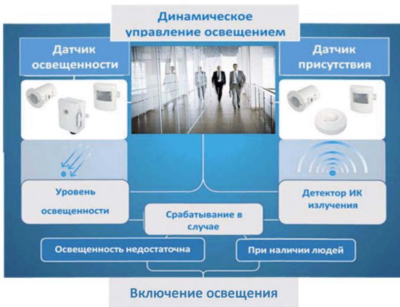
Рисунок 9.3 – Динамическое управление по сигналам датчиков присутствия и освещенности
