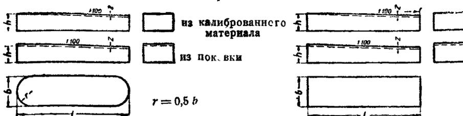
Пример обозначения клиновой врезной шпонки сечением  $18 \times 11$ , длиной 100 мм
