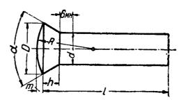
Пример обозначения заклепки железной с полупотайной головкой, диам. 22 мм, дляной 110 мм. ЗАКЛЕПКА ПОЛУПОТ. ЖЕЛЕЗН. 22 × 110 ОСТ 303
