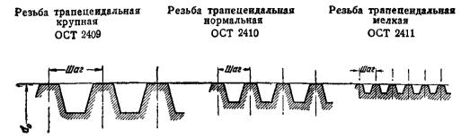
Пример обозначения резьбы трапец. одноход. нормальной правой с диам. 70 мм и шагом 16 мм: TPA∏ 70 × 16 OCT 2410
