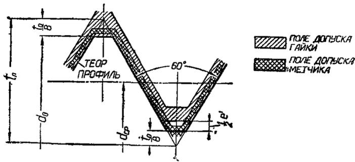
Отклонения отсчитываются от линии теоретического профиля резьбы, от которого отсчитываются отклонения для болтов и гаек по ОСТ НКТП 1251—1256.
