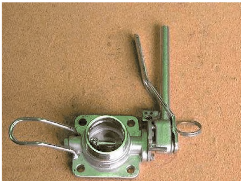
Рис. 11.5-2 Типичный воздушный (паровой) клапан «бабочка»
