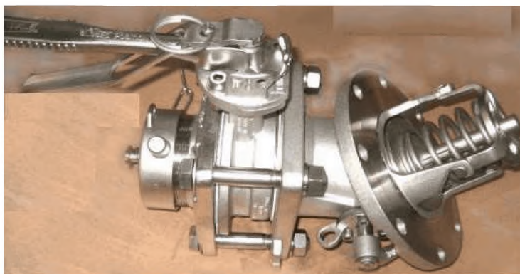
Рис. 11.1 Типичный нижний выпускной клапан
