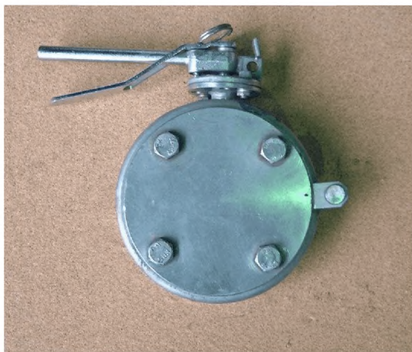
Рис. 11.5-1 Типичный верхний выпускной клапан «бабочка» с фланцем
