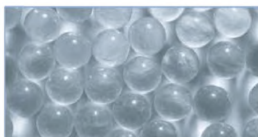
Рисунок 4.35 – Пример микростеклошариков, применяемых в комплексе с разметочным материалом
