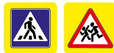
Рисунок 4.24 – Знаки 5.19.2 и 1.23, выполненные на щите со световозвращающей флуоресцентной пленкой желто-зеленого цвета
