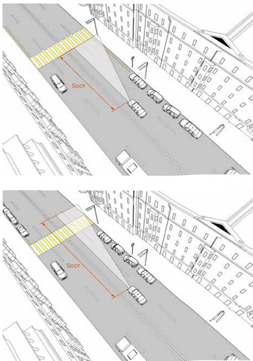
Рисунок 4.31 – Изменение треугольника видимости для условия «пешеход – транспорт» при установке знака 3.27
