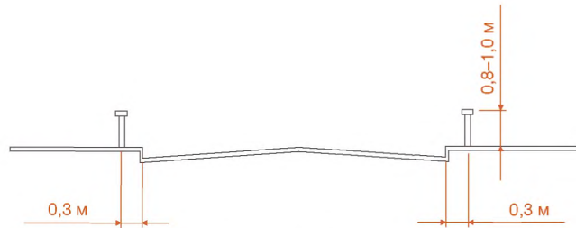
Рисунок 4.19 – Пример использования пешеходных ограждений на подходах к наземному пешеходному переходу. Поперечный профиль
