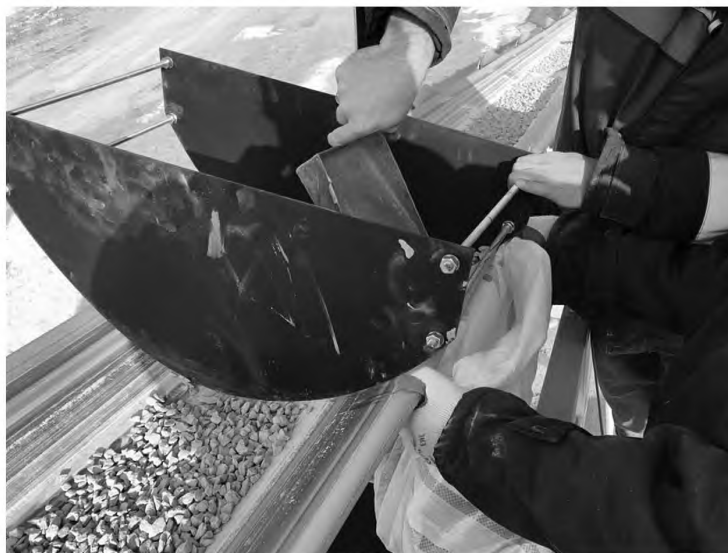
Рисунок 3 — Отбор проб с неподвижной конвейерной ленты при помощи пробоотборной рамы и совка
