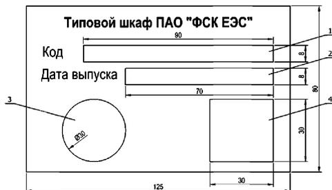
Рисунок 4.3.2 - Эскизный чертеж специализированной таблички (шильдика) типового шкафа (1 – код шкафа; 2 – дата выпуска шкафа в формате ММ.ГГГГ; 3 – поле для товарного знака ПАО «ФСК ЕЭС»; 4 – поле для QR-кода)
