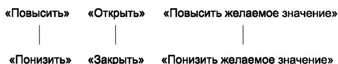
Если устройство регулирования после воздействия на кнопку фиксируется в этом рабочем положении и предусмотрена функция сброса этой фиксации, то для регулирования следует использовать вертикально ориентированную пару кнопок, а кнопку сброса располагают слева от нее на горизонтальной осевой линии, проходящей через центр вертикальной пары кнопок.
