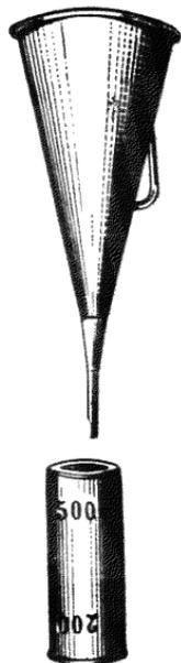
Рис. 2. Вискозиметр СПВ-5 с кружкой.
