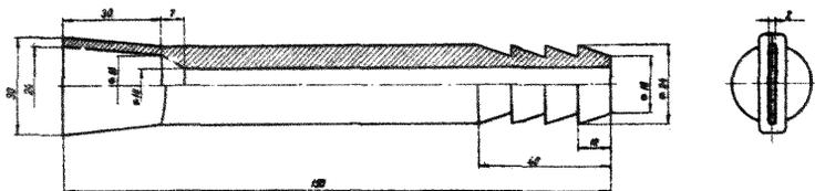
Рис. I. Плоскоструйная насадка
