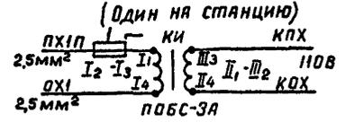
\* Провода Т, ПТ, КОХ и контакты реле НКОП и ЧОСП (ЧКПИ) включаются при наличии переезда на первом участке удаления. При отсутствии переезда питание КОХ подается на обмотку реле 1НПТ и контакт II реле НРУ соединяется с 12 контактом реле НПН.
