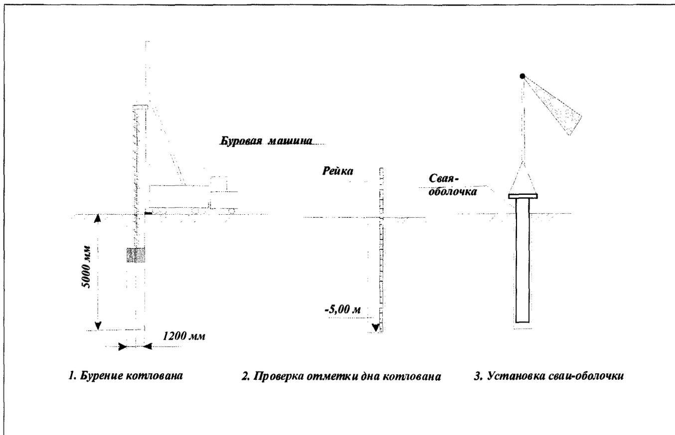
Рисунок 7. Схема бурения котлована и монтаж свай - оболочки
