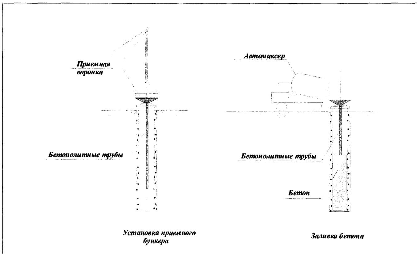
Рисунок 8. Схема укладки бетона в сваю-оболочку методом ВПТ
