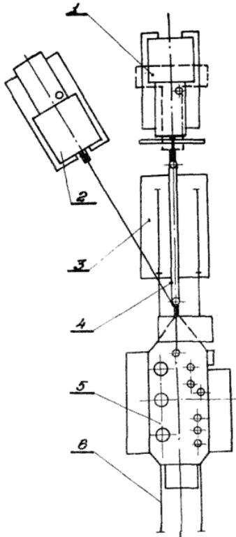
Рис.6. Транспортировка трансформатора на фундамент
