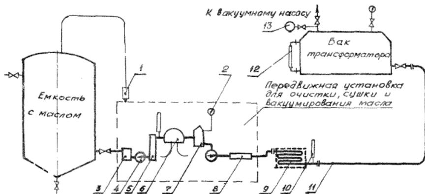
Рис.5. Схема заливки масла в трансформатор
