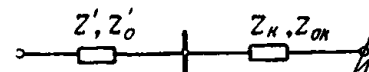
д) Схема замещения отдельных последовательностей для согласования по чувствительности с защитами смежных элементов
