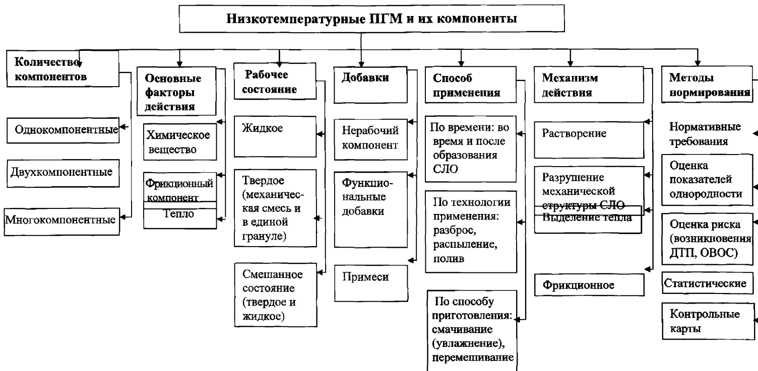
Рисунок 1 – Фасетная классификация низкотемпературных ПГМ и их компонентов по составу, состоянию и технологии применения
