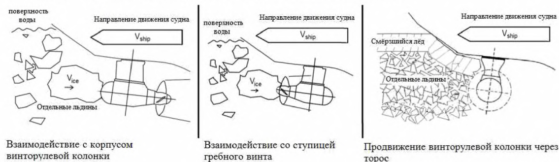
Рис. 10.7.6.5.1 Примеры типовых сценариев нагружения
