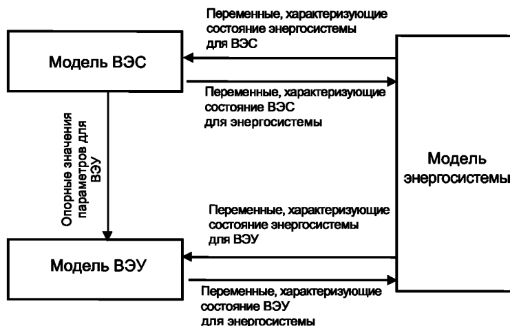
Рисунок 2 — Схема взаимодействий между моделью ВЭУ, моделью энергосистемы и моделью ВЭС
