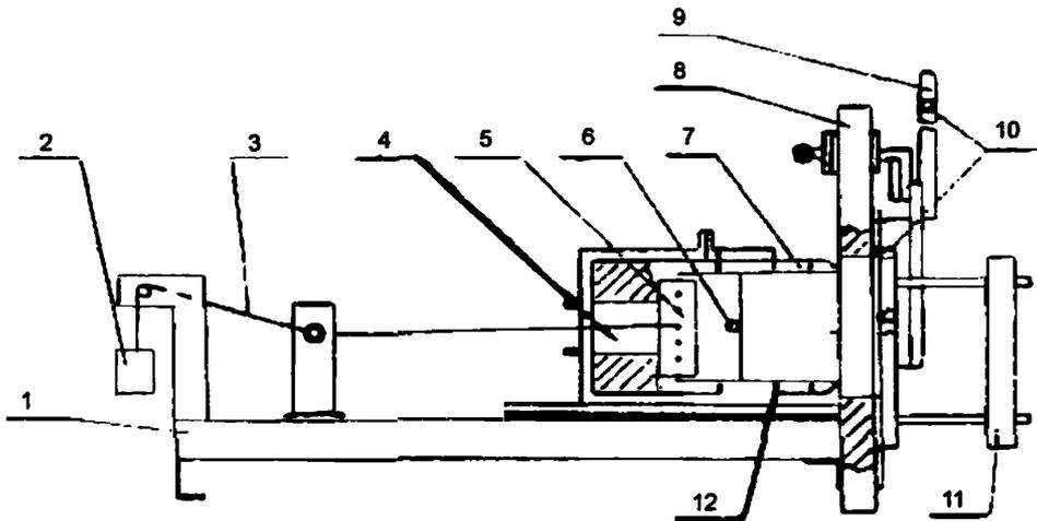
1 – платформа; 2 – груз; 3 – нити; 4 – датчик измерения плотности теплового потока; 5 – зажим; 6 – термопара; 7 – держатель пробы; 8 – экран; 9 – защитная заслонка; 10 – система охлаждения; 11 – источник излучения; 12 – проба
