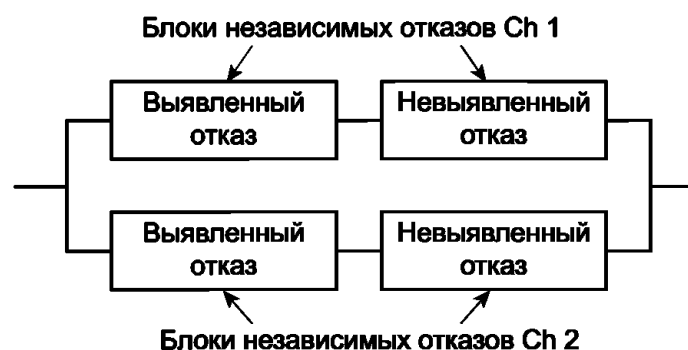
Рисунок 21 — RBD независимых блоков Ch 1 и Ch 2
