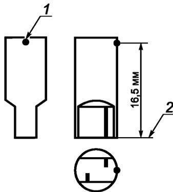
1 — точка измерения, 2 — базовая плоскость
