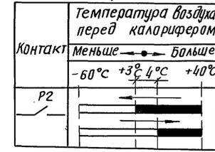
Диаграмма замыкания контакта терморегулятора P3
