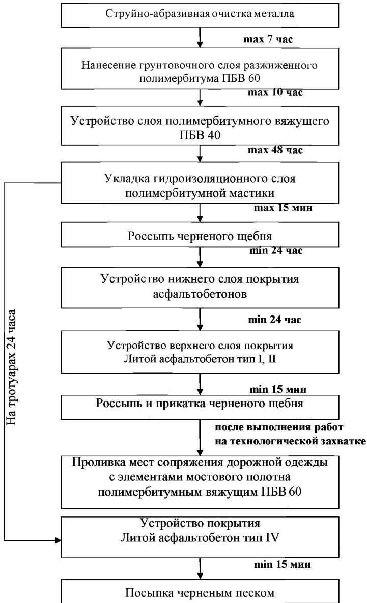
Рисунок В.3 - Схема технологического процесса устройства конструкции дорожной одежды на ортотропной плите проезжей части
